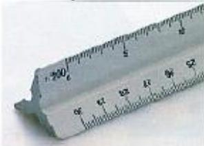
Figura 14 – Exemplo de escalímetro ou escala triangular
